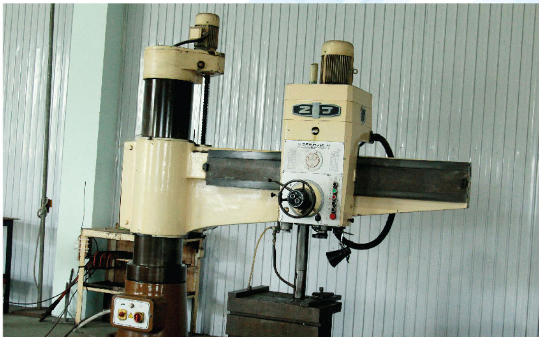
Máy khoan cần PLC
