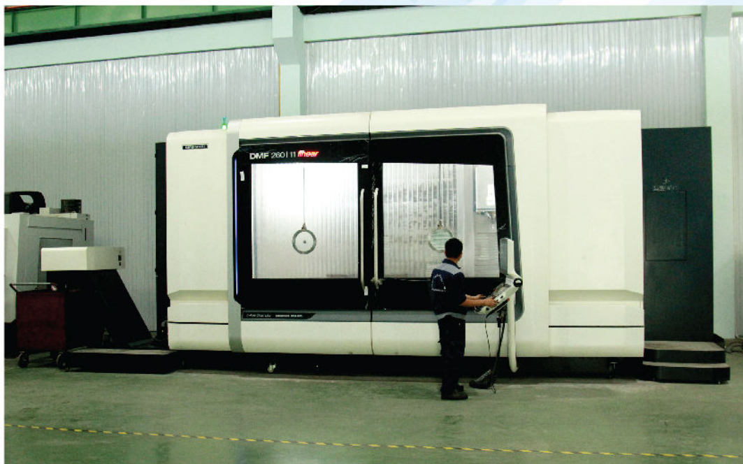
Trung tâm gia công CNC: > DMG Mori DMF 260-11 KGT Machining center- horizontal > DMF260-11
