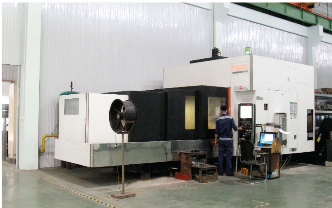
Trung tâm gia công CNC: > CNC Vertical Machining Ceter > Mazak FJV 60/120II
